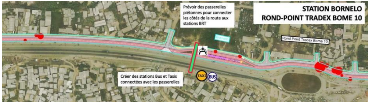
Figure 59: Recommandations d'aménagement au niveau de la station Bornelo
