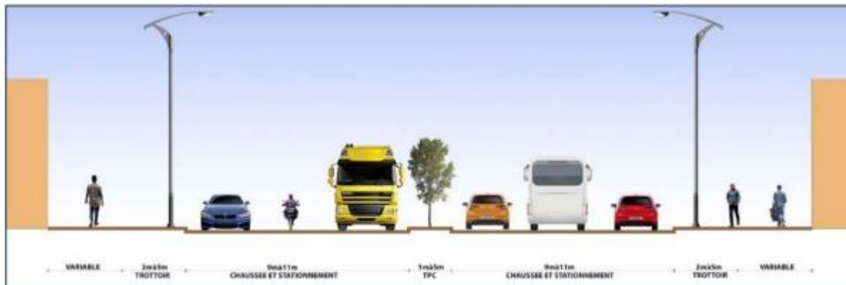
Figure 6 : Profils en travers type existant et projeté sur la séquence N°5
