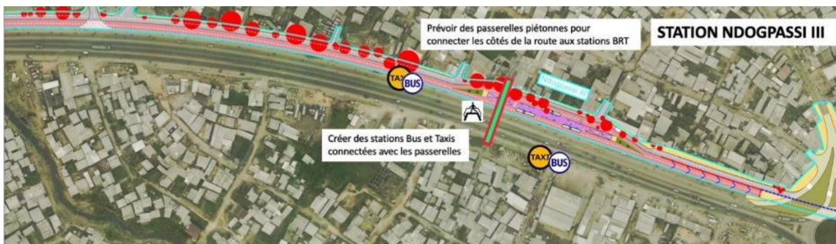
Figure 58: Recommandations d'aménagement au niveau de la station Ndogpassi III
