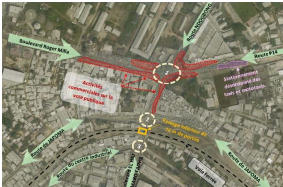
Figure 4 : Illustration de l'état actuel des voies existante sur le nœud de Ndokoti
