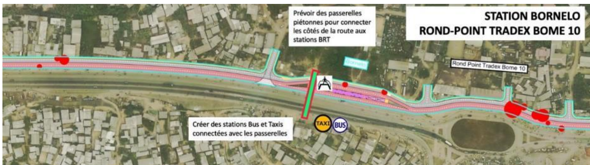
Figure 34: Recommandations d'aménagement au niveau de la station Bornelo
