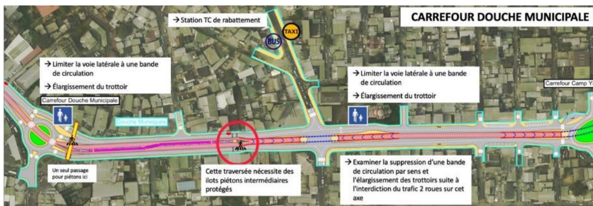
Figure 24: Recommandations d'aménagement au niveau du carrefour Douche Municipale
